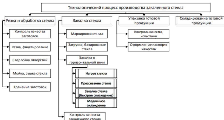
Рисунок 1 – Структурная схема технологического процесса закалки стекла
