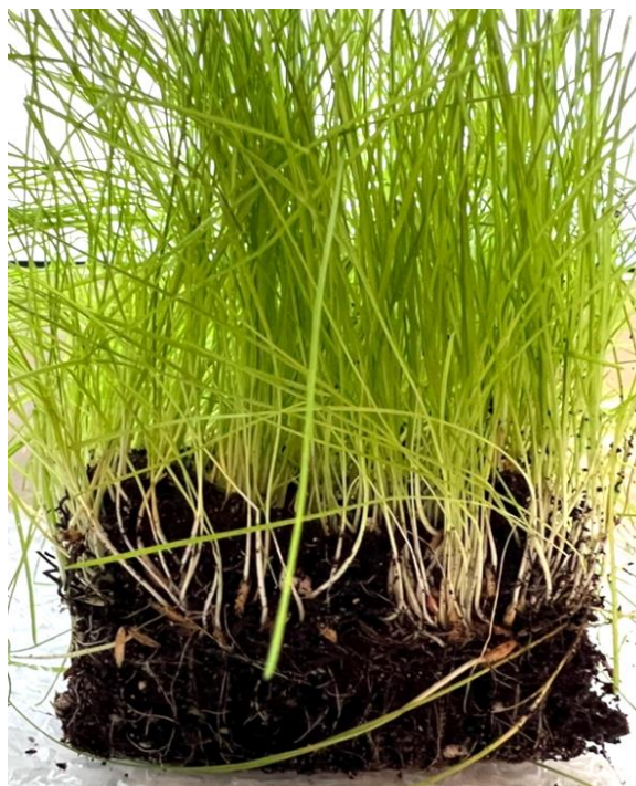
Рисунок 2 – Разрез противозэрозионного материала – геомата Энкамат 7225 с грунтом, засеянным травой сорта «Райграс»
